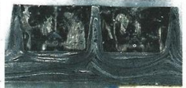
フレックスカーボンでつくった靴底の断面図。極薄の炭素繊維が重なり、ピンの代わりとなる突起の先端まで入り込んでいる。＝サンコロナ小田提供
